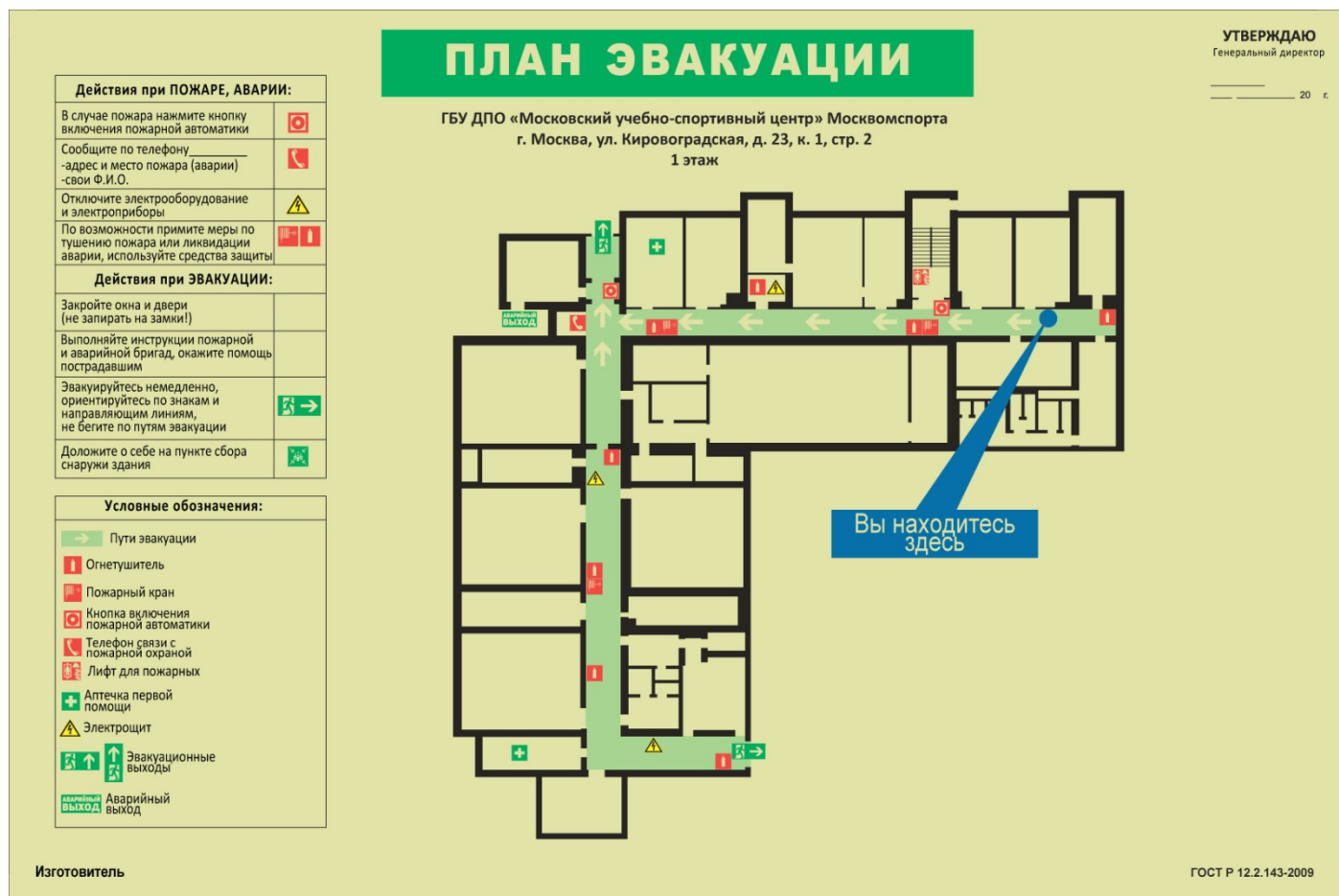
Рисунок Д.1 - Этажный план эвакуации (для этажа в целом)
